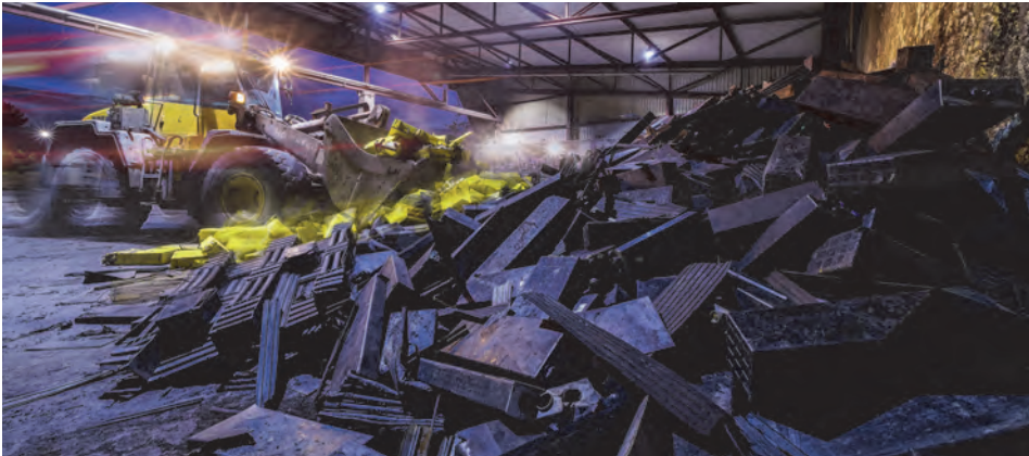
Sammlung und Rückführung von ausgedienten Blei-Säure-Batterien
