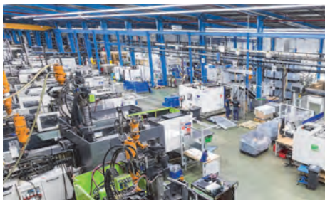
Voll- oder teilautomatisierte Montageanlagen ermöglichen eine effiziente Produktion von Baugruppen
