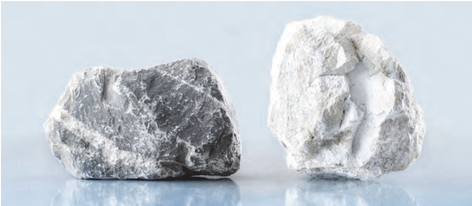
Links ungebrannter Kalkstein, rechts gebrannter Kalk
