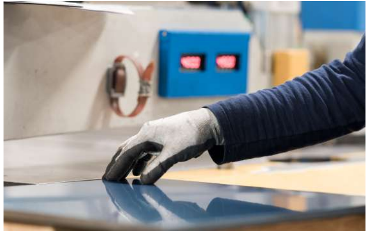
Produktion von Edelstahl-Ronden mit Folienbeschichtung
