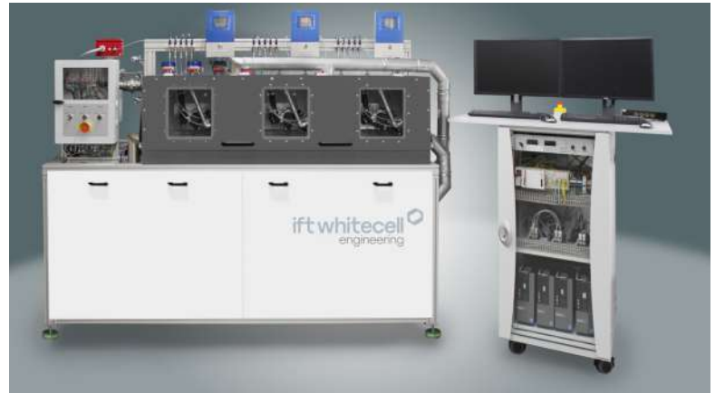
Prüfstand für Versuche an intelligenten Thermomanagement-Modulen für Kühlwasser
