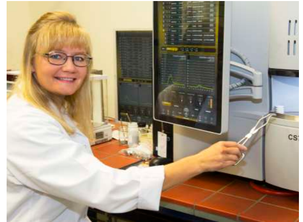
Kohlenstoff- und Schwefelbestimmung mittels Verbrennungsanalytik
