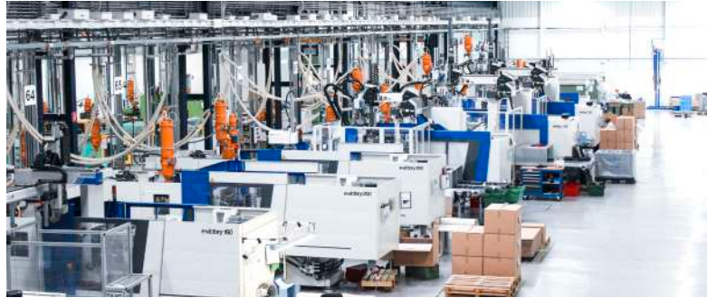
Circa 60 Spritzgussmaschinen produzieren komplexe, aerodynamisch optimierte Ein- und Mehrkomponententeile für Automobilhersteller und Zulieferer weltweit
