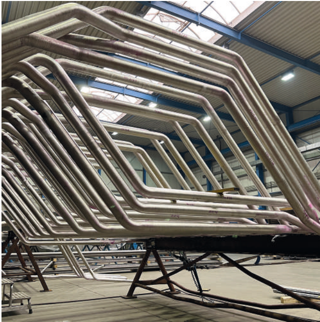
Schweißplattierte Gitterrohre für den Einsatz in einer Müllverbrennungsanlage
