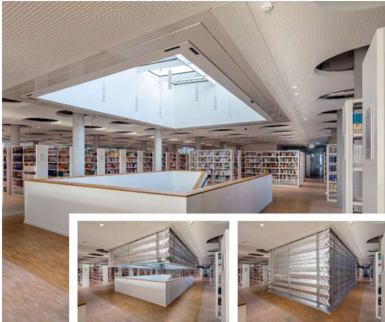
Das Portfolio von STÖBICH umfasst neben technischen Brandschutz- und Batteriesicherheitsprodukten innovative bauliche Brandschutzsysteme wie den hier gezeigten raumbildenden Feuerschutzvorhang
